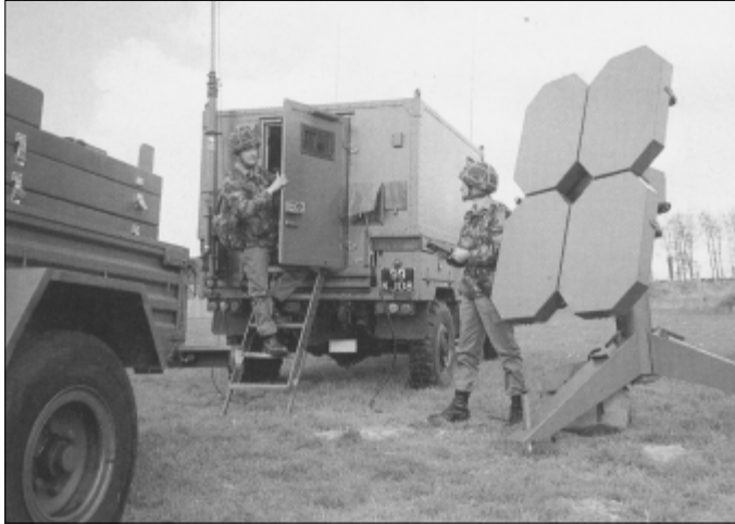
Рис. 3. Специальный прицеп с радиолокационным оборудованием к финскому автомобилю «Ваисала»
